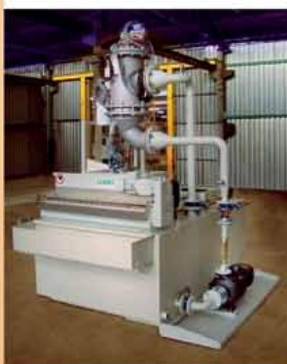
Filteranlage und Ölinebelabscheider zur Filterung von Schleifemulsionen.
